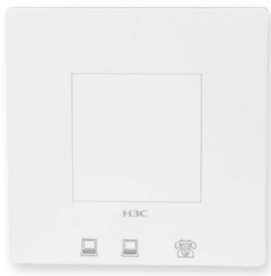
图 1 WAP712H 面板式无线接入设备
